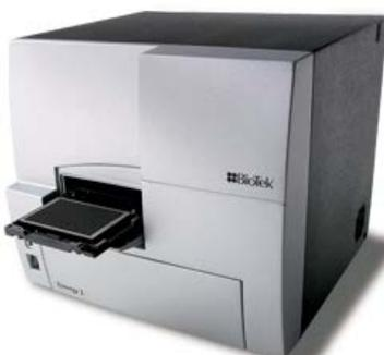
Mesure avec le luminomètre
