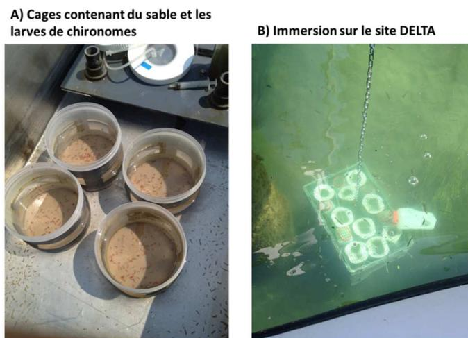
Figure 19 : Exemple de cage (A) et disposition des systèmes dans le lac du Bourget (B)
