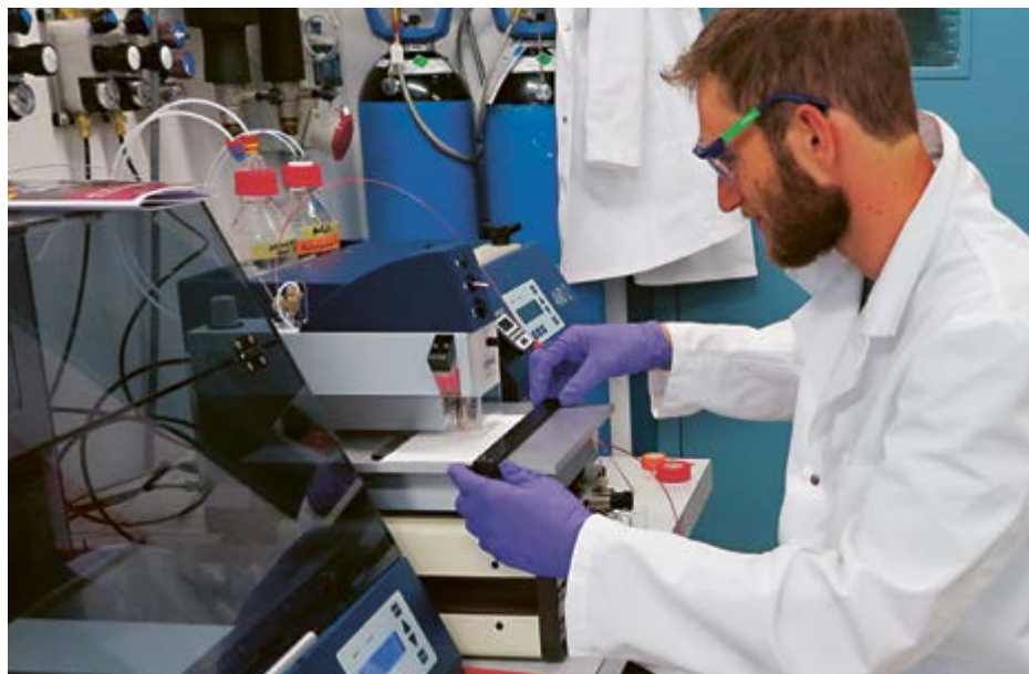
Alan Bergmann positionne une plaque à couche mince pour découper une bande – rendue visible par des biotests – et examiner sa structure chimique.
