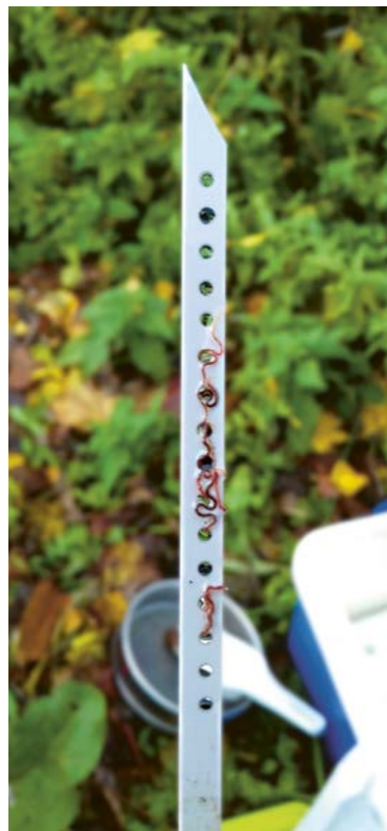
Les bandes d'appâts sont utilisées pour mesurer la dégradation de la matière organique sur le terrain.
