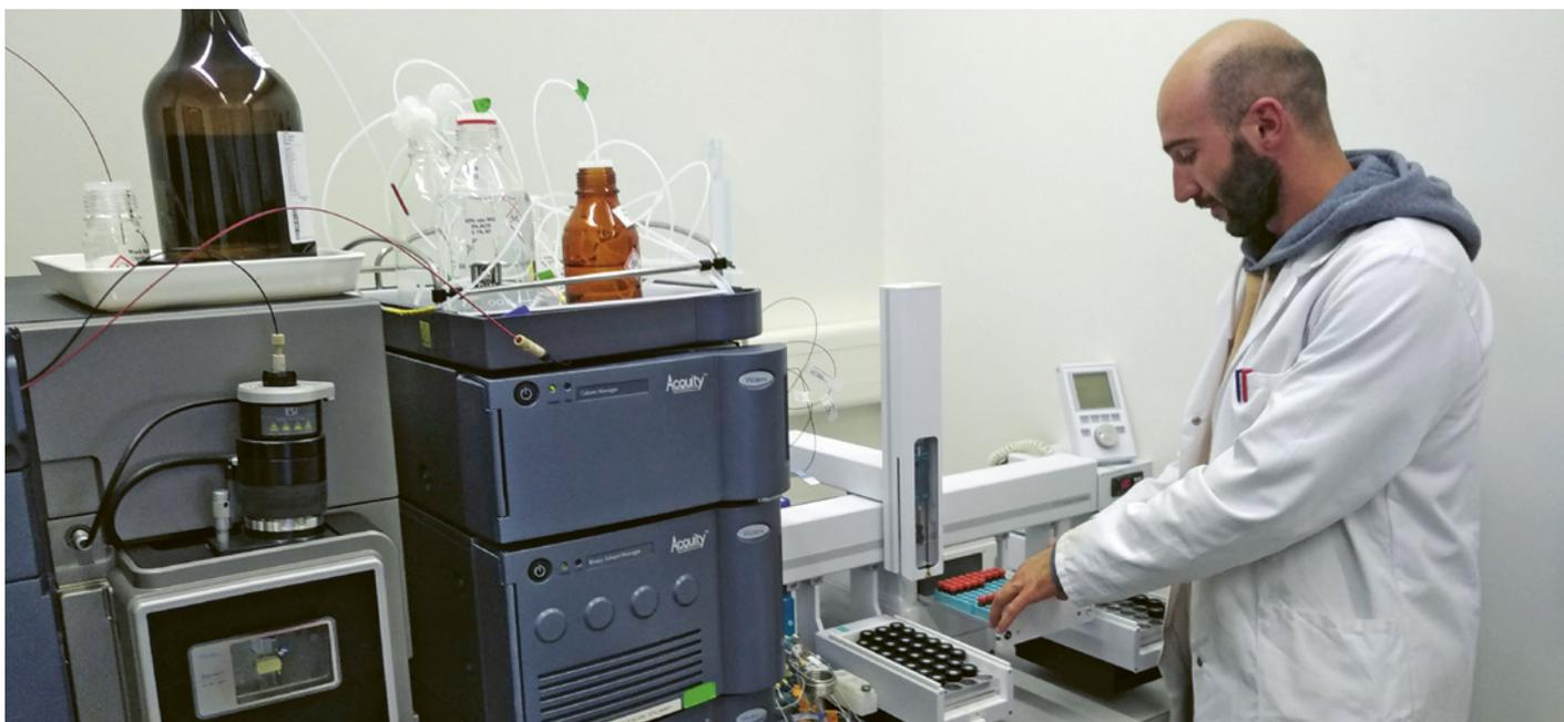
Thibault Masset étudie les substances potentiellement toxiques issues de l'usure des pneus en utilisant la chromatographie liquide couplée à la spectrométrie de masse (LC-MS / MS).
