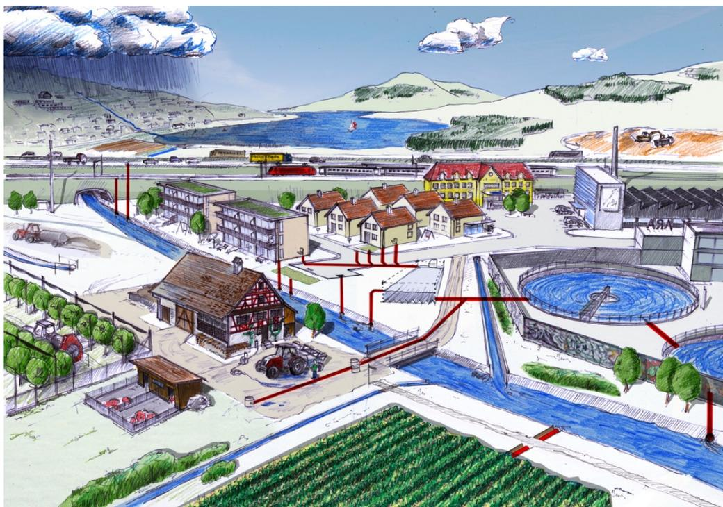
**Figure 1** Principales sources et voies de rejet (en rouge) des micropolluants. On entend par rejets diffus tous ceux qui ne transitent pas par les stations d'épuration. (©Illustration : OFEV)
