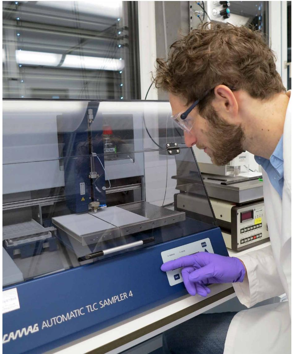
Les échantillons sont déposés sur la plaque à couche mince où ils sont séparés en fractions plus petites.
