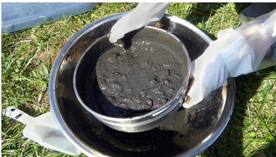
Avant de poursuivre l'analyse, les sédiments doivent d'abord être tamisés à la granulométrie souhaitée.
