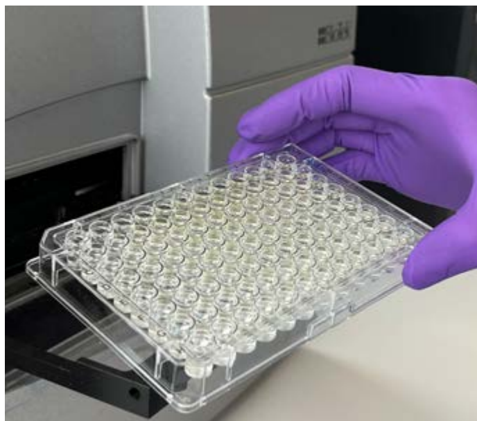
La croissance des algues sur la plaque de microtitration est mesurée au photomètre.
