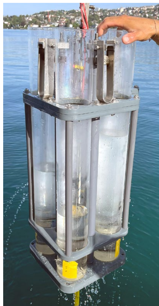
Des matières en suspension ont été collectées dans le lac Léman à l'aide de pièges à matières en suspension.
