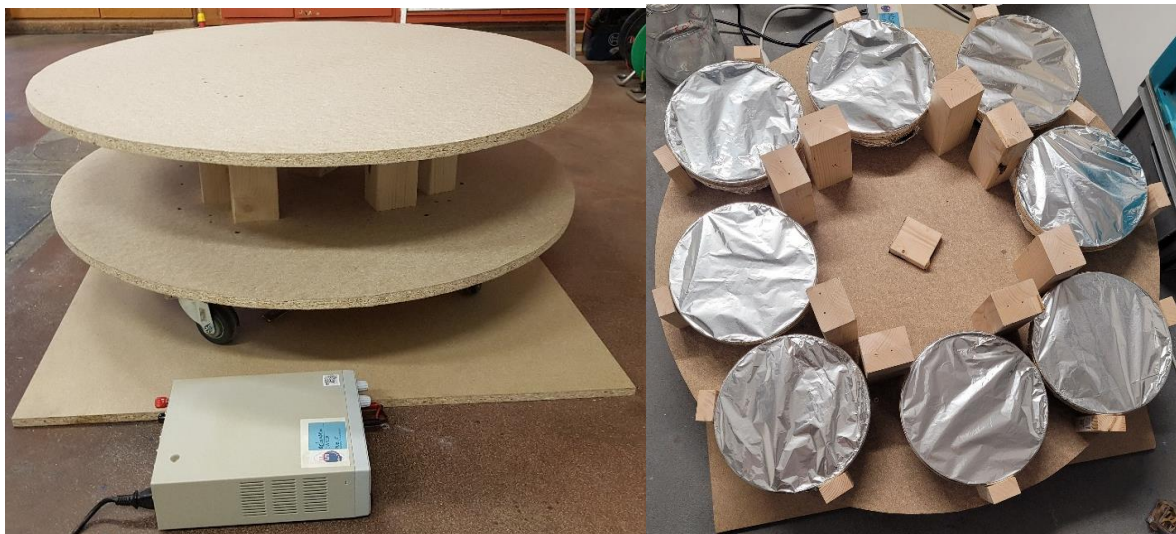
Abb. 8: Links: Drehtisch. Rechts: Untere Etage des Drehtisch mit den installierten Proben.
