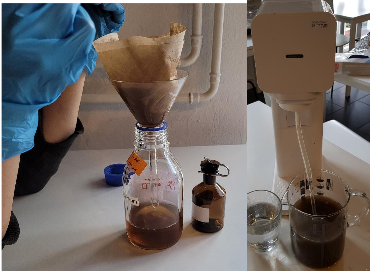
Abb. 9: Links: Filtration der Eluate. Rechts: pH-Neutralisation eines Eluates durch CO 2 -Beigabe.
