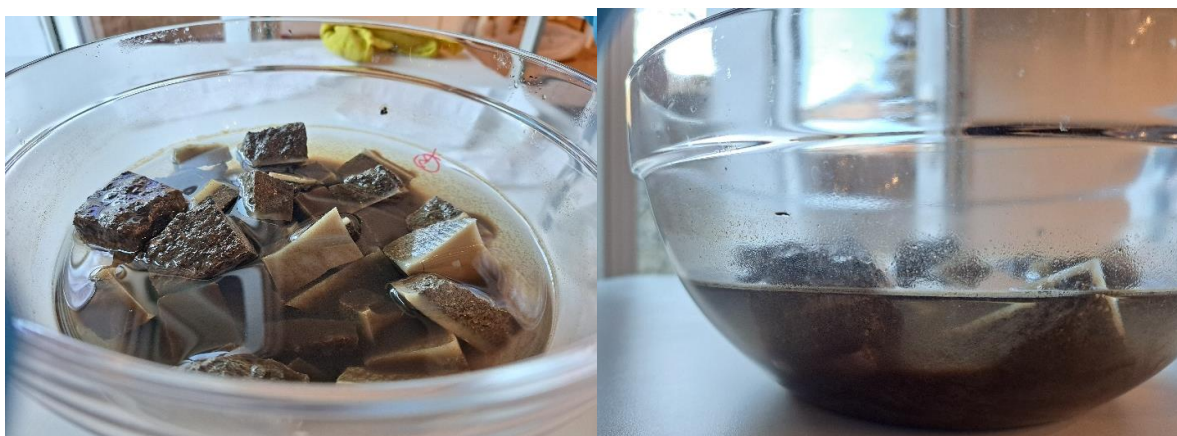
Abb. 7: Zerkleinerte Probe vor der Auswaschung in der Auswasmischung.
