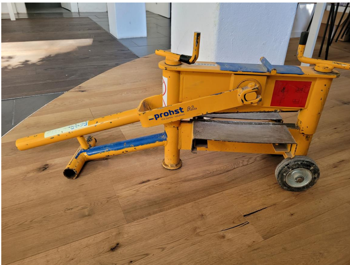
Abb. 5: Der Steinknacker wurde verwendet um die Proben zu zerkleinern.
